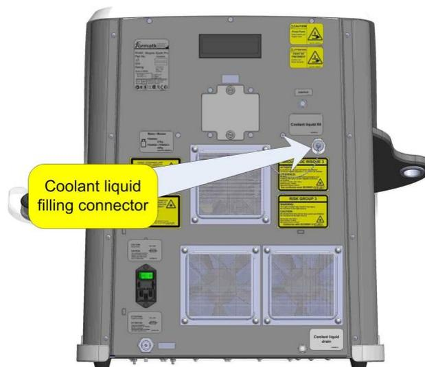
Figure 36: Remplissage de liquide de refroidissement
